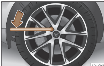
Sl. 37 Zamjena kotača: otpuštanje vijaka kotača.
