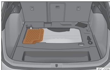
Sl. 227 Plug-in hibridna vozila (PHEV): mjesto ugradnje akumulatora u prtljažniku
